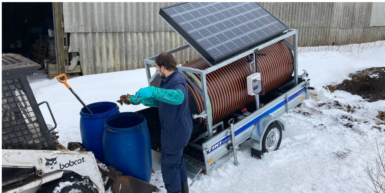
Prototüüp fermenteerija- segaja- kuivati, mis töötab "off-gridina" päikeseenergia abil.
